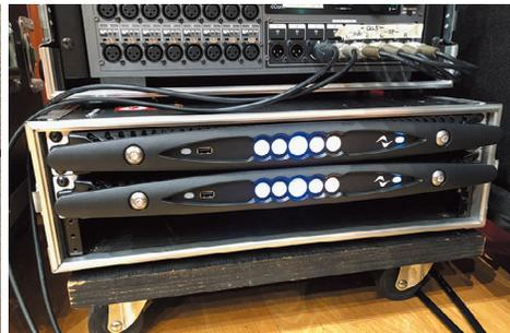
パワー・アンプは「Powersoft X4」。標準で「ShowMatch」のプロファイルが搭載されている
